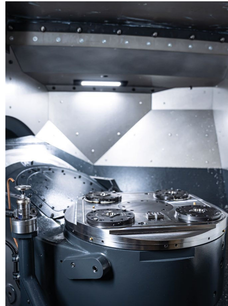
Für eine optimale Ausnutzung des Arbeitsraumes, verfügen die beiden DMU 60 eVo über ein direkt in den Tisch eingelassenes MTS-Nullpunkt-Spannsystem.
